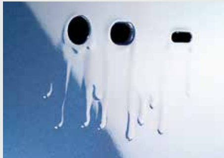
Rimozione di colature di vernice
